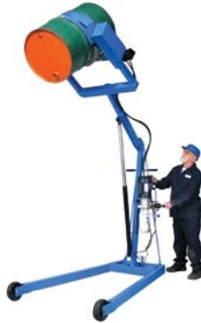
**LEVAGE MANUEL** - Pour les unités de 60" de hauteur de versement, l'inclinaison est contrôlée par une manivelle. Les unités de 72" et 96" offre l'inclinaison contrôlée par une roue à chaîne.
